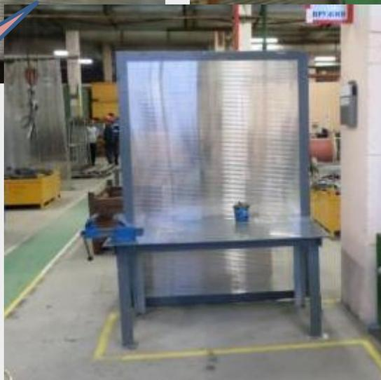
*Перегородки простейшей конструкции, изготовлены из ячеистого прозрачного листа из поликарбоната*
