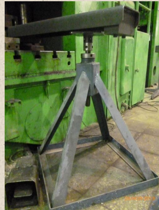
МВМ (18 цех) Специализированная подставка для поддержания длинномерных балок при обработке
